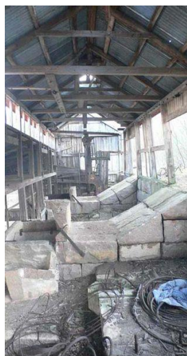
Lahälla knottfabrik er et unikt kulturminne. Et maskinstenhuggeri for mekanisk hogging av smågatesten. En fallhammer er fortsatt inntakt. Knottfabriken er i dag under restaurering og har en aktiv venneforening.
