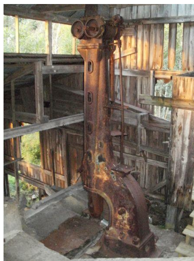
Lahälla knottfabrik er et unikt kulturminne. Et maskinstenhuggeri for mekanisk hogging av smågatesten. En fallhammer er fortsatt inntakt. Knottfabriken er i dag under restaurering og har en aktiv venneforening.
